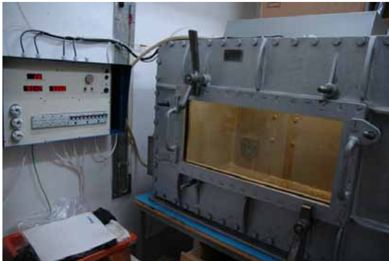
Obr. 5. Hypobarická hypoxická komora. Regulační jednotka (vlevo) udržuje požadovanou nadmořskou výšku (hypoxii) kontrolovaným přívodem vzduchu do komory.
